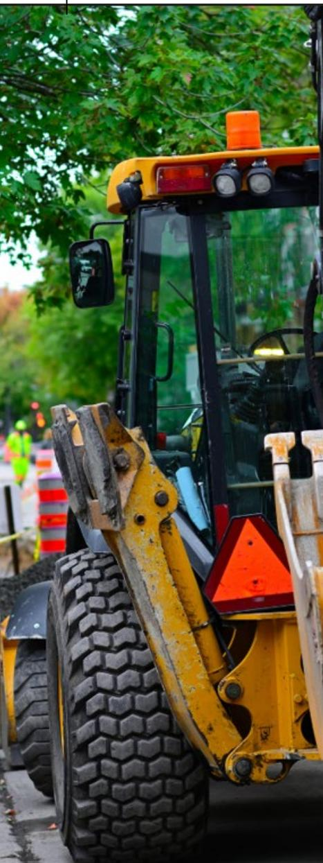
Los incidentes de atropello al retroceder se pueden minimizar desarrollando un plan de control de tráfico interno, mejorando la visibilidad, implementando sistemas de advertencia efectivos, asegurando el posicionamiento adecuado de los trabajadores, reduciendo las distracciones, utilizando barricadas, mejorando la comunicación, brindando capacitación y manteniendo medidas de seguridad consistentes.
